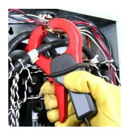
**Photo 2**: Install CT Around Conductor.
